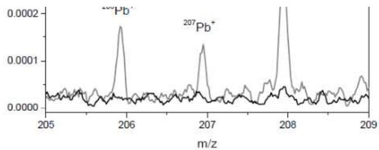
**Figura 2.20:** espectros de masas con y sin campo en la región del plomo; espectro adquirido en
