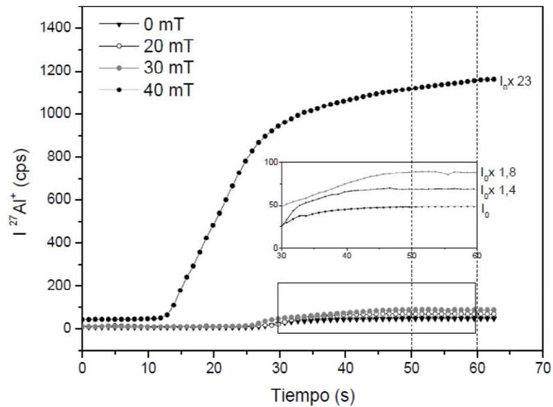
**Fig. 2.17:** señal iónica del aluminio ( $m/z = 27$ ) adquirido en el equipo rf-GD-TOFMS a unas condiciones de 400 Pa de presión y 40 W de potencia, en presencia de diferentes campos magnéticos. Para facilitar la interpretación del gráfico se incluye una vista ampliada de la región sombreada. Se indica la zona en la que se han calculado los factores de incremento respecto a la intensidad registrada en ausencia de campo así como dichos factores.
